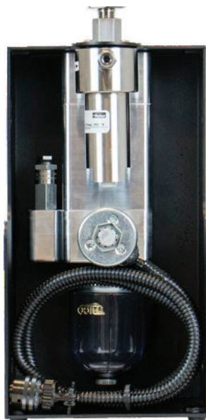
Рисунок 8.6-А - Система автоматической защиты от загрязнения (CPS)
