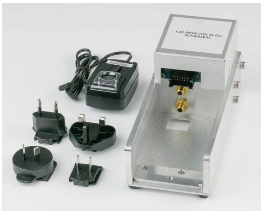
Рисунок 8.5.1 – Комплект для удаленной калибровки встроенного преобразователя
